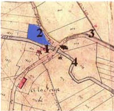
Le martinet d'Offemont en 1827. N°1 le martinet, n°2 réservoir, n°3 route de Belfort à Offemont, n°4 canal
