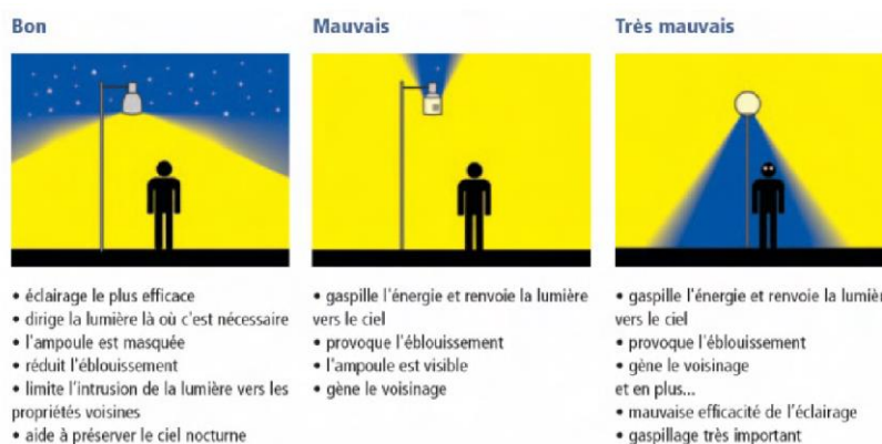
Trois types de luminaires, celui de gauche représente le choix optimal (source : ASCEN)
