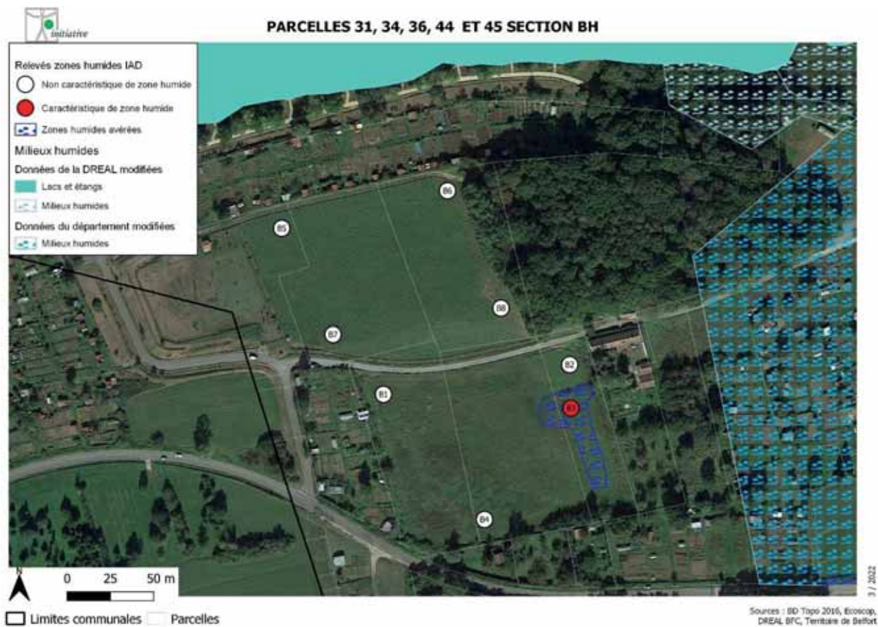
Figure 27 : Relevés et détermination du caractère humide des parcelles 31, 34, 36, 44 et 45 section BH - Source : IAD.
